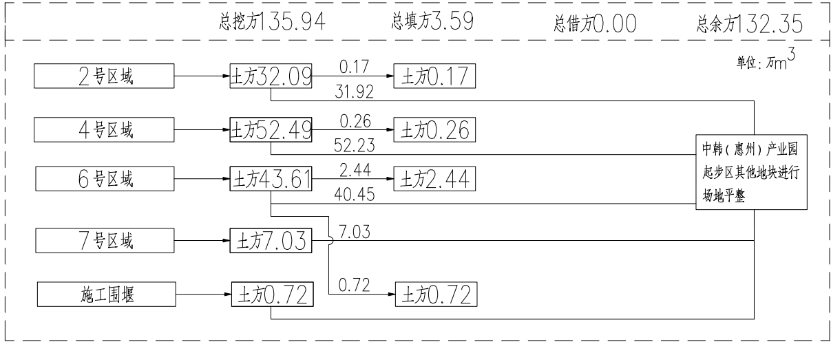
图 1.1-5 土石方流向框图 (万 m 3 )
